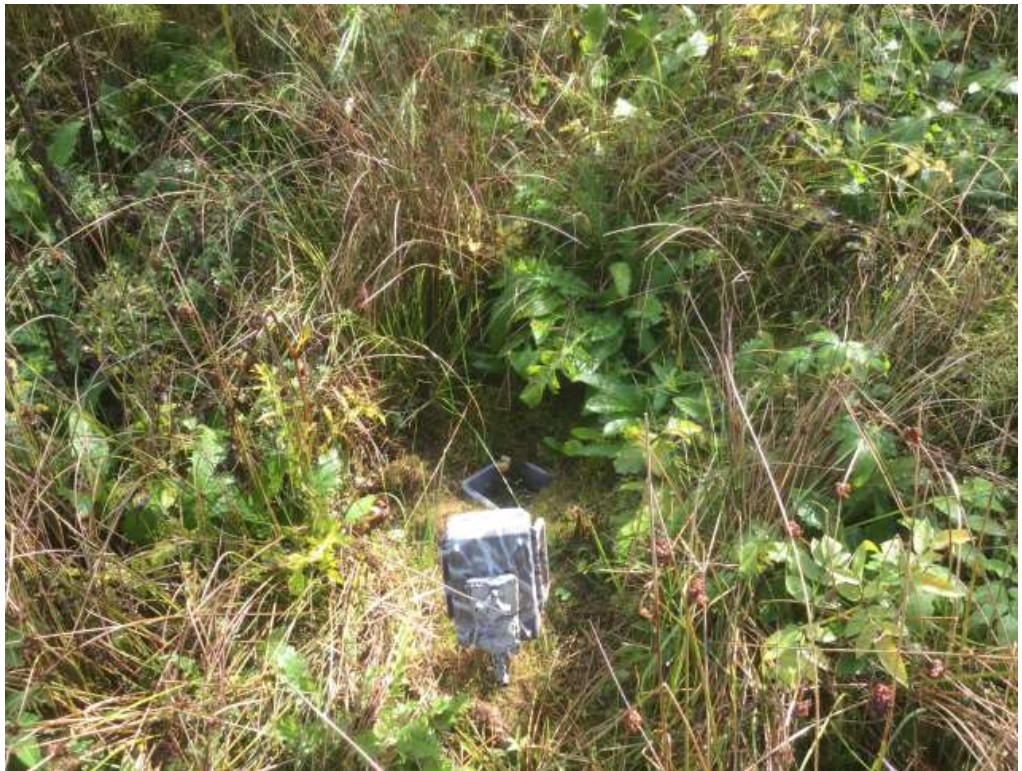
Figur 1. A/ Et eksempel på hvordan et kamerastativ kan udformes. Kameraet skrues på den vinkelrette ende af stativet til højre. Bunden af plastikkar er fastgjort til stativet. Spidsen i enden sørger for en god forankring i jorden. B/ Opstillingen af kamerastativ og foderkar i felten (Foto: Jeroen van der Kooij & Julie Dahl Møller).
