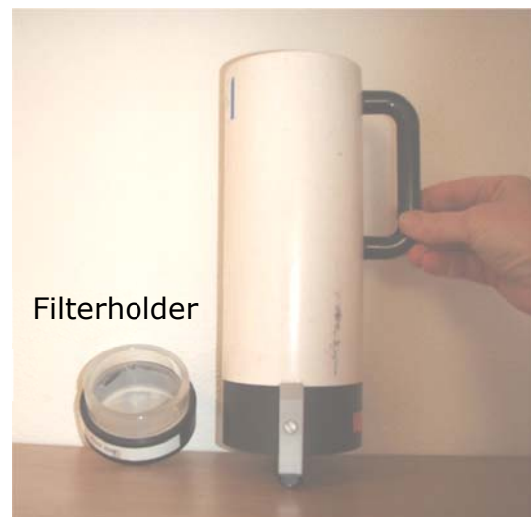
Figur 3.2. Filtreringsudstyr til benyttelse i felten vist i vertikalt tværsnit samt foto. Nettet på filterholderen kan udskiftes (tegning efter Lauridsen et al., 2007).
