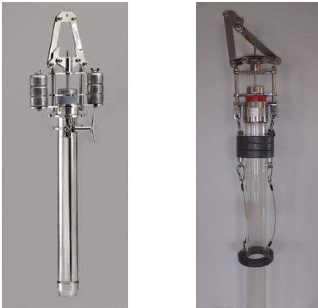
Figur 6.2a Kajak bundhenter med påmonteret rør. Foto KC Denmark A/S (venstre), Jens Christensen (højre).
