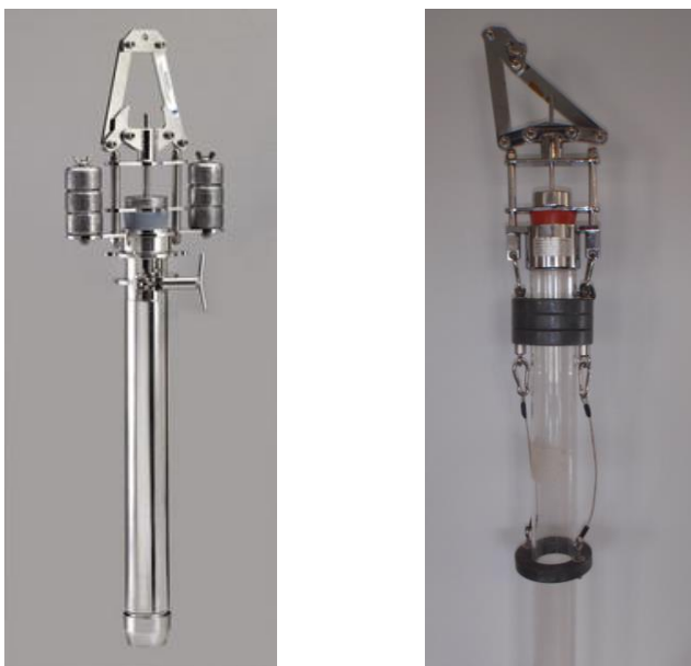
Figur 6.2a Eksempler på Kajak bundhenter med påmonteret rør. Foto KC Denmark A/S (venstre), Jens Christensen (højre).
