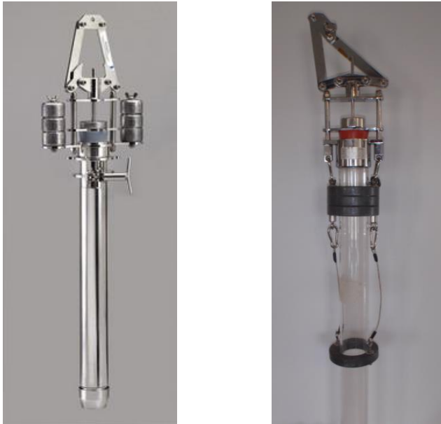
Figur 7.1a Kajak bundhenterer med påmonteret rør. Foto KC Denmark A/S (venstre), Jens Christensen (højre).
