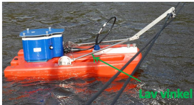
Figur 5. Figuren viser et ADCP instrument monteret på en wire, og med en spids vinkel imellem instrumentet og stangen der forbinder instrument og wire.
