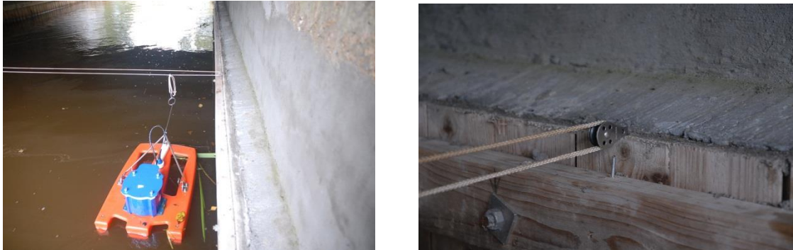
Figur 1. Billedet til venstre viser et eksempel på et ADCP instrument, der er monteret på et wiretræk, opstillet under en bro. Billedet til højre viser blokken der benyttes til wiretrækket.
