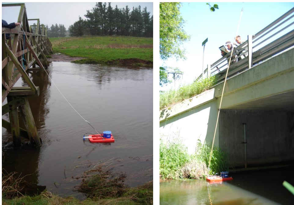
Figur 3. Figuren til venstre viser et eksempel på en bromåling udført med tov. Billedet til højre viser et eksempel på en bromåling udført med stang.
