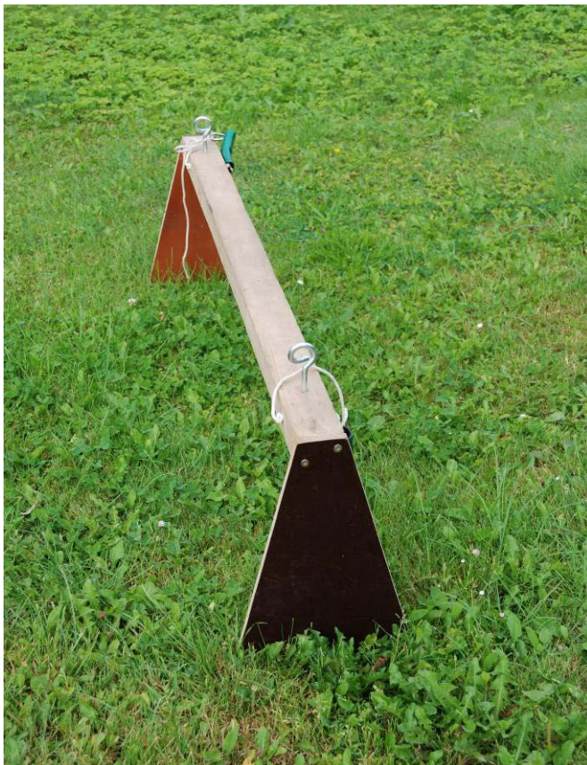
Figur 2. Bom til fastgørelse af tov/wire ved brug af gummibåd i ikke-vadbare vandløb. Bommen placeres på tværs af gummibåden – umiddelbart bag sædet. Bommen skal være så bred, at den lige akkurat kan "klemmes" ned over ydersiden af båden. Bommen fastgøres ved hjælp af nylonsnor til bådens på siderne placerede bærehåndtag. Tov/wire føres igennem de to metalkroge. Det gør fastgørelse og frigørelse af tov let.
