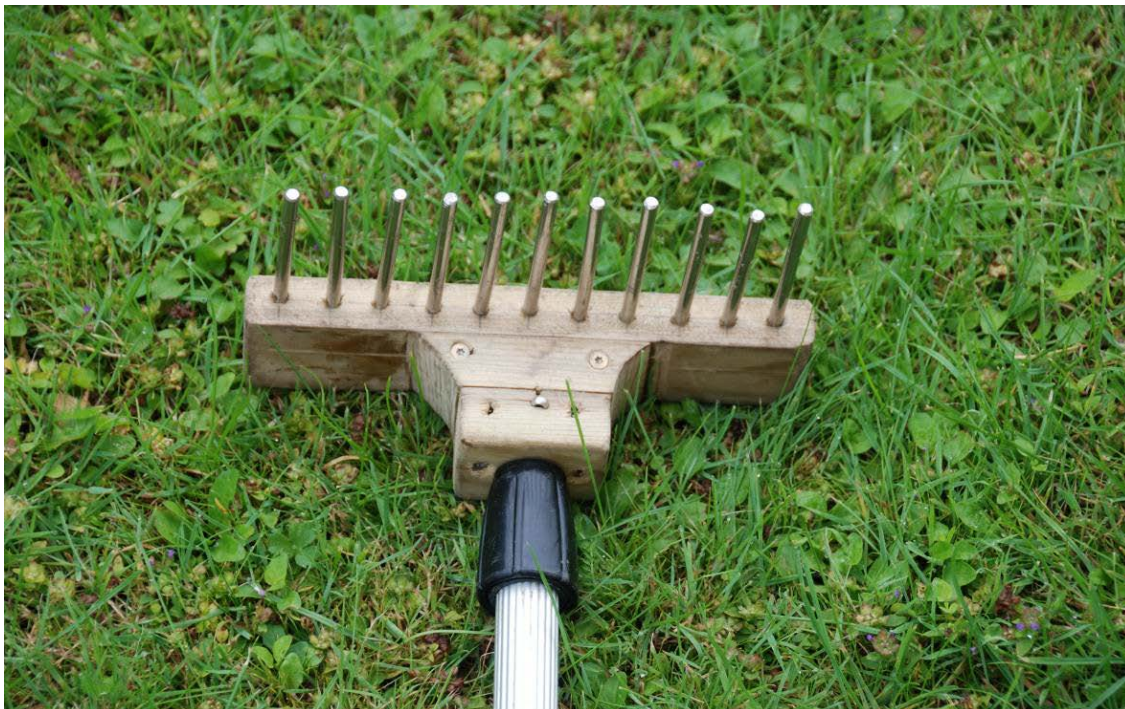
Figur 3. Planterive monteret på teleskopstang særlig velegnet til brug ved registrering af planter, substrat og dybde fra båd – hvor vandet er uklart eller for dybt til brug af vandkikkert. Rivehovedet har følgende dimensioner: Bredde – 200 mm, tændernes længde – 80 mm, tykkelse – 6 mm, afstand mellem tænder – ca. 13 mm.
