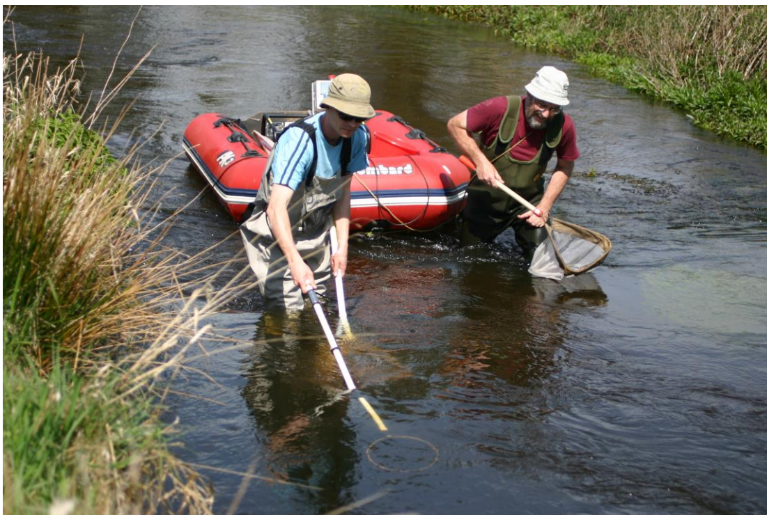
Figur 1. Generator, ensretterboks og baljer er placeret i gummibåd, som trækkes af medhjælperen. Dette minimerer tidsforbruget ved håndtering af de fangne fisk, ligesom man undgår problemer med at kablet sætter sig fast. (Jens Skrivers foto).
