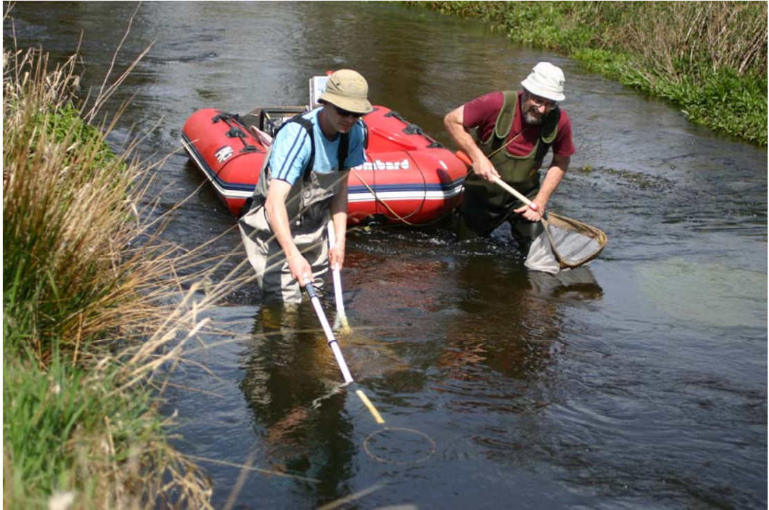
Figur 2. Generator, ensretterboks og baljer er placeret i gummibåd, som trækkes af medhjælperen. Dette minimerer tidsforbruget ved håndtering af de fangne fisk, ligesom man undgår problemer med at kablet sætter sig fast. (Jens Skriver foto).
