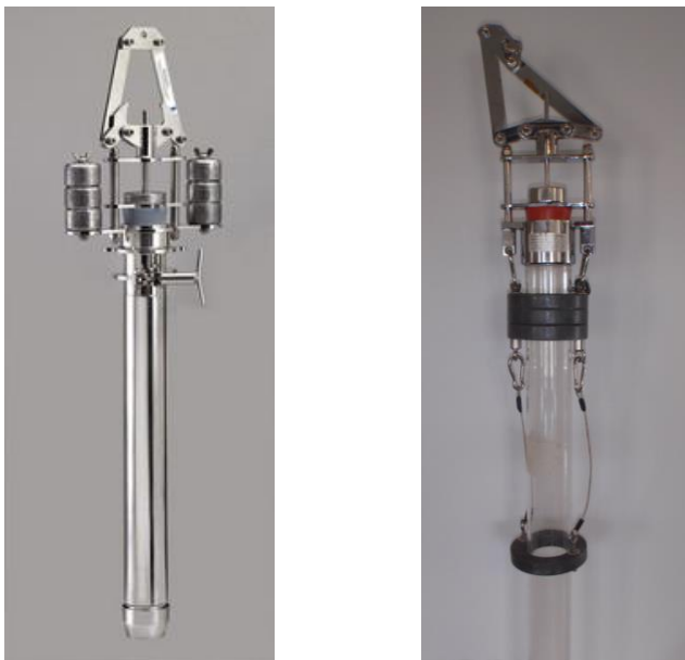
Figur 7.1a Eksempler på Kajak bundhenterer med påmonteret rør. Foto KC Denmark A/S (venstre), Jens Christensen (højre).
