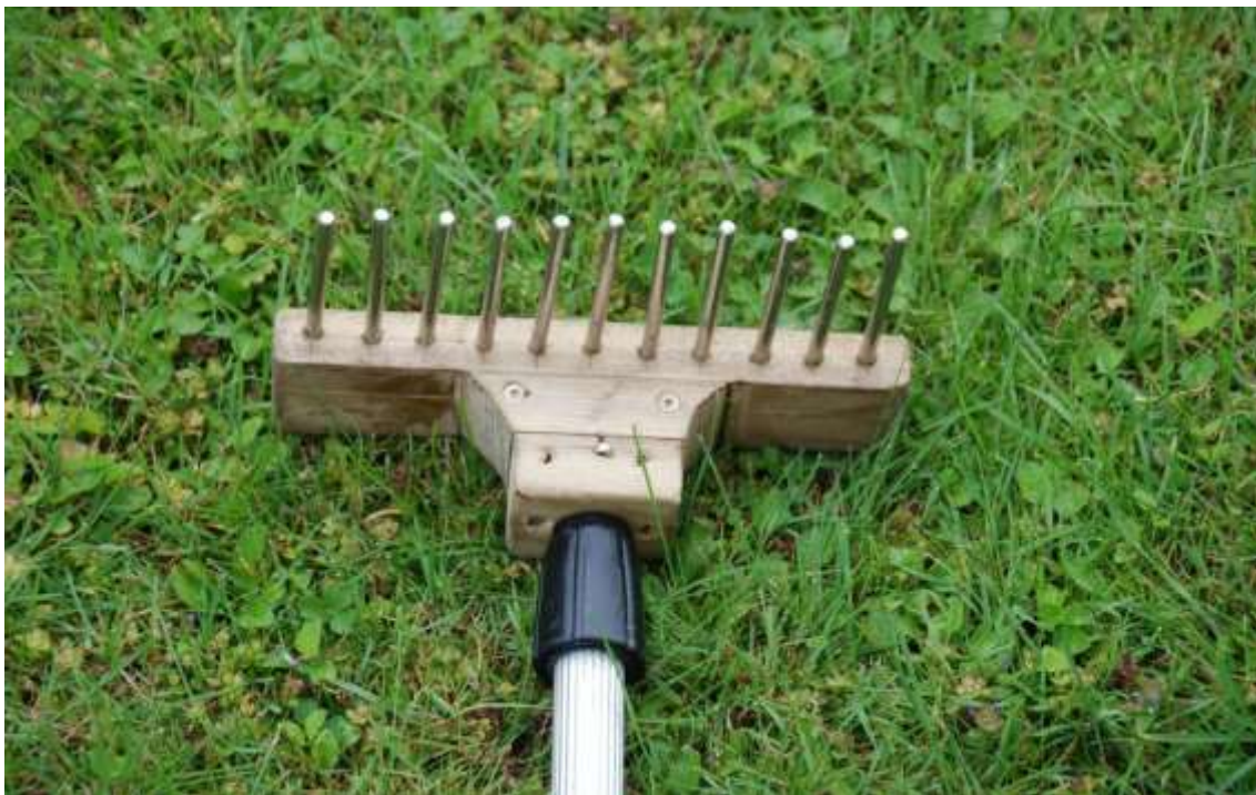
Figur 3. Eksempel på planterive monteret på teleskopstang særlig velegnet til brug ved registrering af planter, substrat og dybde fra båd – hvor vandet er uklart eller for dybt til brug af vandkikkert. Rivehovedet har følgende dimensioner: Bredde – 200 mm, tændernes længde – 80 mm, tykkelse – 6 mm, afstand mellem tænder – ca. 13 mm.
