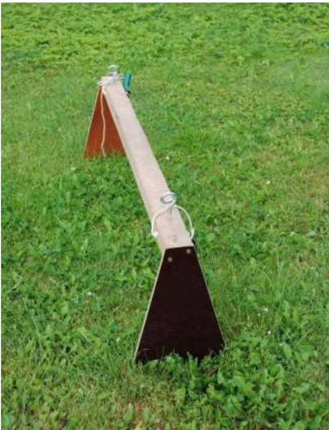
Figur 2. Bom til fastgørelse af tov/wire ved brug af gummibåd i ikke-vadbare vandløb. Bommen placeres på tværs af gummibåden – umiddelbart bag sædet. Bommen skal være så bred, at den lige akkurat kan "klemmes" ned over ydersiden af båden. Bommen fastgøres ved hjælp af nylonstrømpe til båden, på siderne placerede bærehåndtag. Tov/wire føres igennem de to metalkroge. Det gør fastgørelse og frigørelse af tov let.
