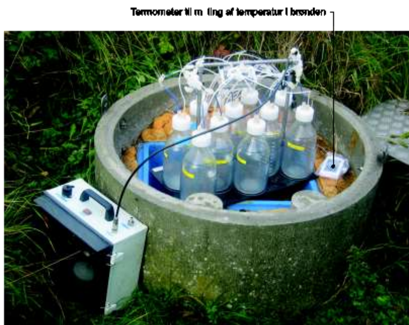
a. Stativ med 10 opsamlingsflasker og vakuumpumpe
